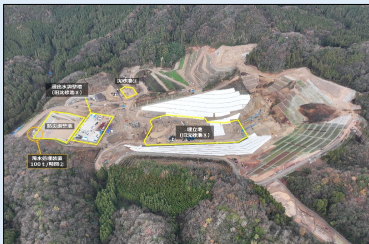
①②仮設沈砂池及び浸出水調整槽等の配置位置図(2022年12月撮影) ※防災調整池の整備や仮設沈砂池の形状を変えながら2022年12月時点で約82,800m 3 を確保
