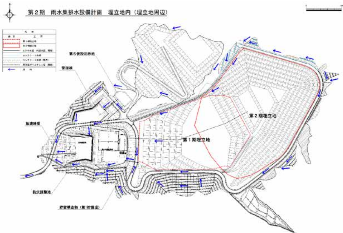
図 1.6-14 雨水集排水設備配置図 第2期工事
