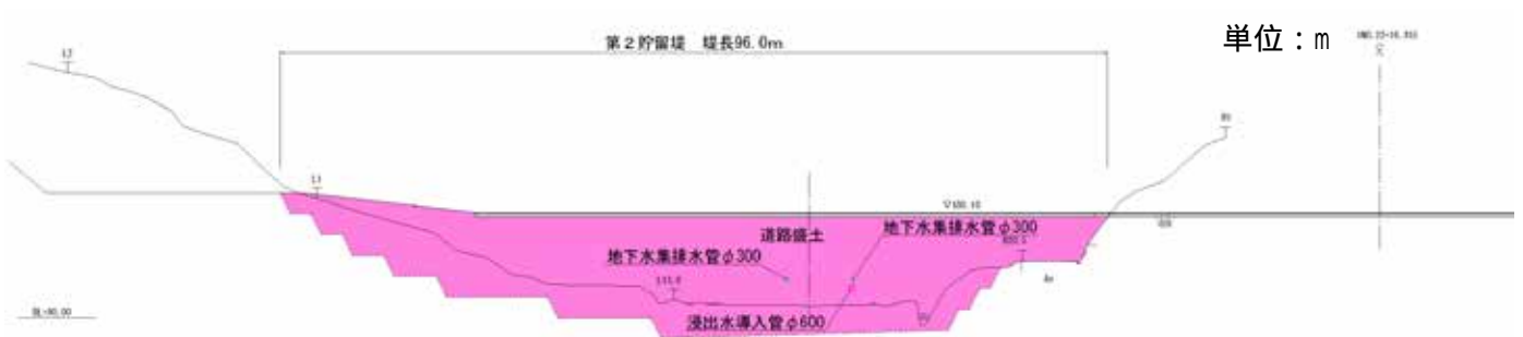
图 1.6-7 第 2 貯留堤 (第 3 期工事) 断面图
