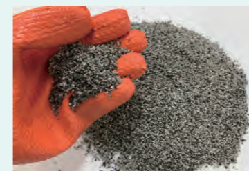
廃タイルカーペットから製造した再生ポリ塩化ビニル(エコフレック)
