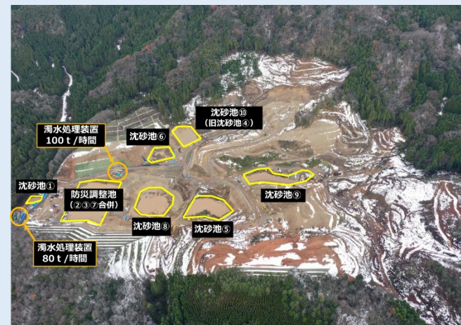
①仮設沈砂池及び防災調整池等の配置図(2020年12月撮影) ※防災調整池の整備や仮設沈砂池の拡張、増設を通じて2020年12月時点で約35,600m 3 を確保
