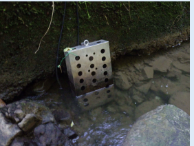
⑤濁水の常時監視（深谷川中流）
