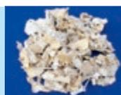
ダンボールや石膏ボードの紙の部分は圧縮処理され、製紙メーカーで原材料として利用され、再びダンボール等の紙製品となります。
