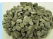
破砕機で一定のサイズにまで砕いたコンクリートや、機械選別によりサイズを揃えた土砂等は、路盤材や埋め戻し材として生まれ変わります。
