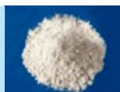
石膏ボードは特殊な処理によって石膏粉と紙に分けられます。石膏粉は再び石膏ボードとして生まれ変わり、建材として使用されます。
