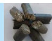
廃棄物処理の際に発生する粉じん（ホコリ）は、ほかの廃棄物と混ぜて固め、エコ・フォームとなり、製鉄用のフォーミング抑制材として利用されます。
