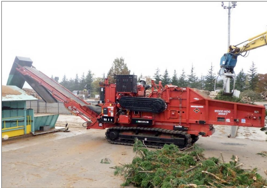
今般導入したハンマー式破碎機「ウッドホグ」
